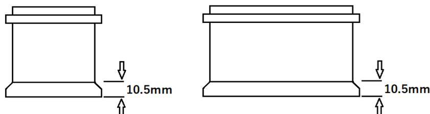
長側面と短側面のリブの高さ10.5mm
